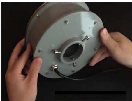
Su aro de fuente está diseñado para ensamblarse en el tubo de salida de la fuente. De tal manera que el chorro que sale verticalmente pueda ser iluminado a 360 grados. Para eso es necesario aflojar los tornillos del diámetro interior del aro. Colocarlos sobre el tubo y después apretarlos hasta fijarla en su lugar.
